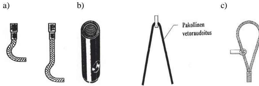
Kuva 19 a) käyräankkuri, b) hylsyankkuri, jonka kanssa on aina käytettävä riittävää vetoraudoitusta, c) käyrä- ja hylsyankkurin sisään kierrettävä vaijeri nostolenkki
