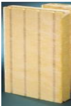
Kuva 27 Betonisandwich-elementeissä käytetty uritettu mineraalivillalevy. Urien jakoväli on 150...200 mm ( www.isover.fi ).
