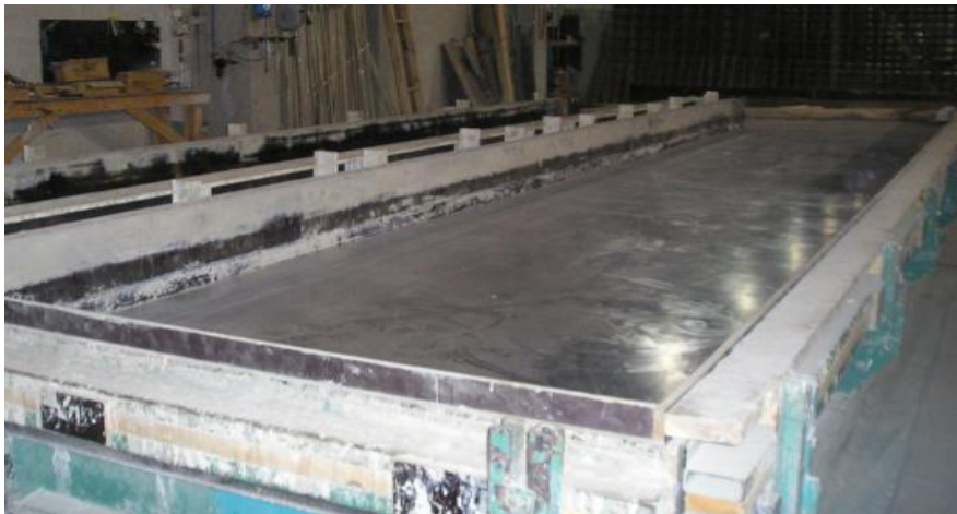
Kuva 23 Julkisivuelementtien valmistamiseen soveltuva muottipöytä
