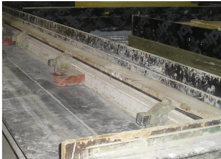
Kuva 68 Tavallista korkeampi muottilaita, jossa on tukirunkona alumiiniprofiili
