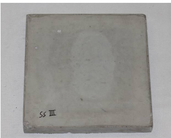
SS III – sisäseinä / teräsmuotti / paineellinen pesu
