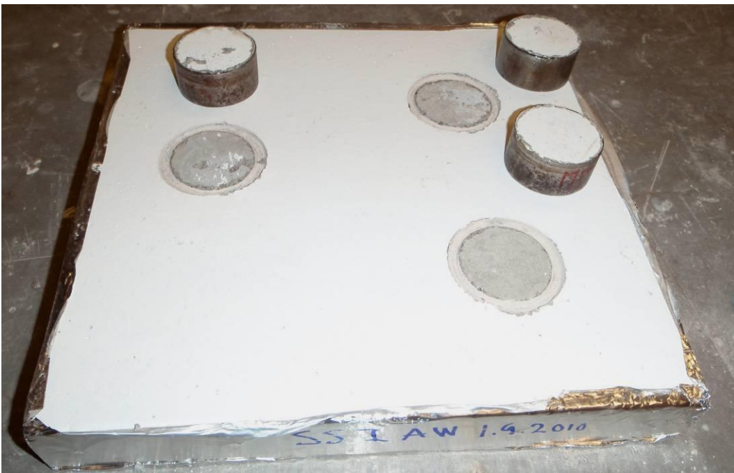
Betonin ja tasoiheen välinen tartuntamurto, esimerkki
