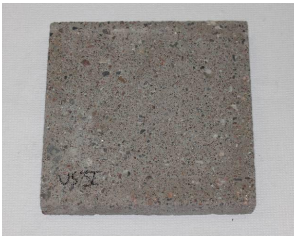
US V – ulkoseinä / Minicote / paineellinen pesu
