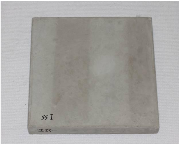
SS I – sisäseinä / teräsmuotti / ei käsittelyä
