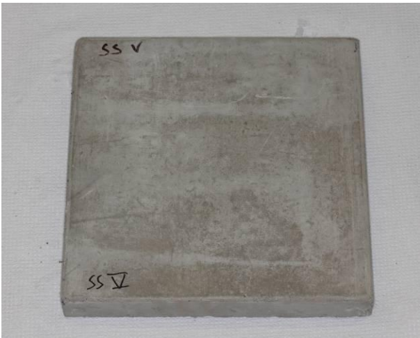
SS V – sisäseinä / teräshierto / laikkaus
