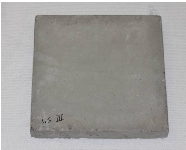
US III – ulkoseinä / teräsmuotti / paineellinen pesu
