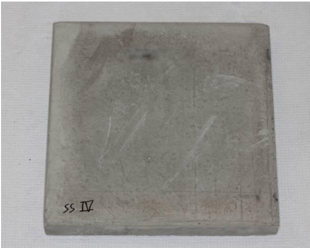
SS IV – sisäseinä / teräsmuotti / laikkaus
