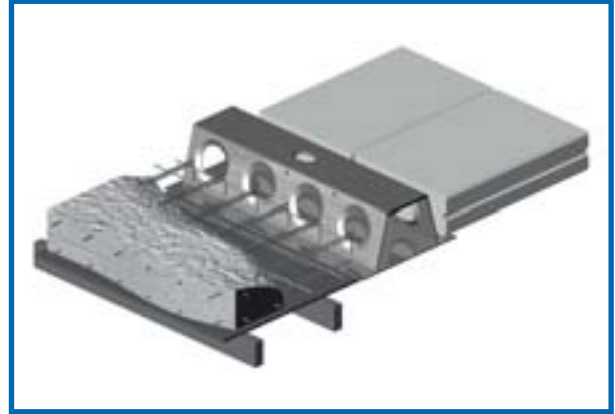
Kuva 2. Deltapalkki siporexlaattaelementtien kanssa ja paikallavalussa.
