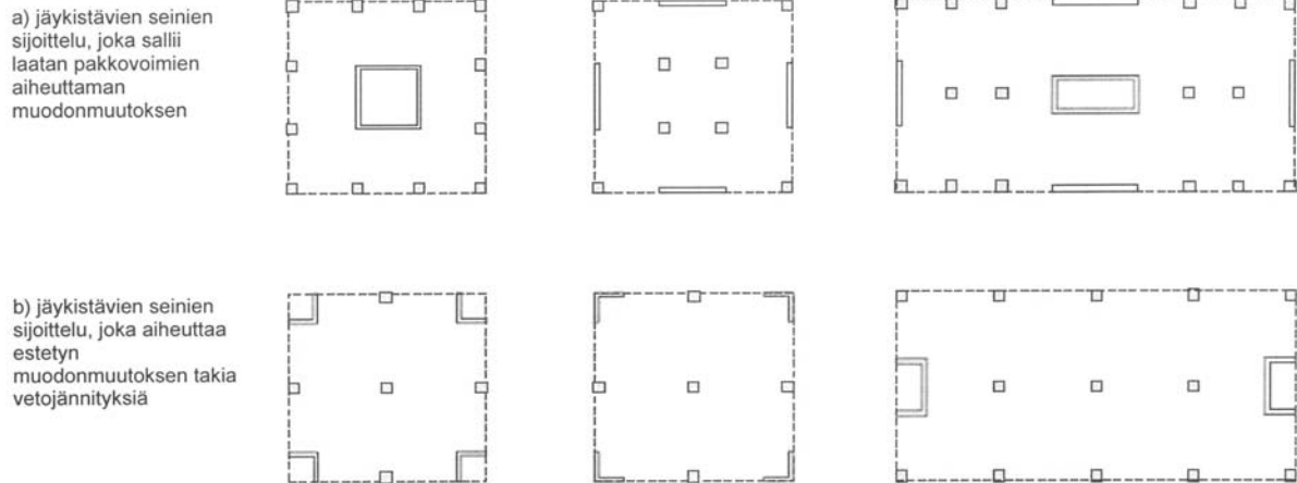
Kuva 1. Jäykistävien seinien sijoittelun vaikutus laatan vetojännityksiin.
