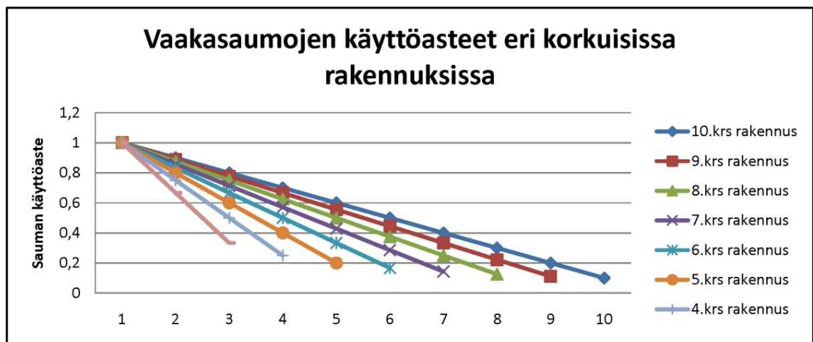
Kuva 2 Vaakasaumojen käyttöasteet eri korkuisissa rakennuksissa kun alimman sauman käyttöaste on 100% ja muut tekijät ovat vakioita, valmis rakennus. Vaaka-akselilla on sauman numero alhaalta lukien.
