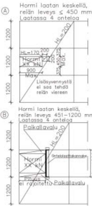
8 Esimerkki, jossa hormi laatan keskellä.
