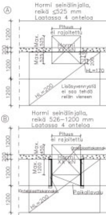
10 Esimerkki, jossa hormi seinälinjalla. Kun reunimmaisessa laatussa on isoja reikiä, laatan reuna on tuettava pituus-suuntaiseen seinään.
