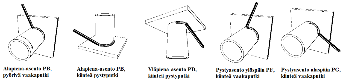
Kuva 3. Piena-asennot putken hitsauksessa [3].
