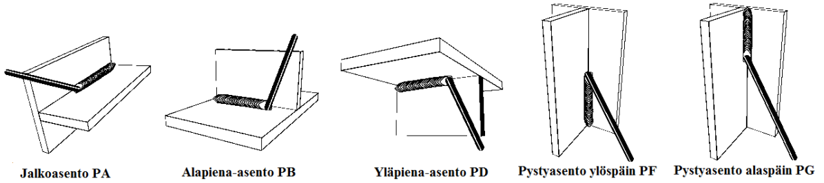
Kuva 2. Piena-asennot levyhitsauksessa [3].
