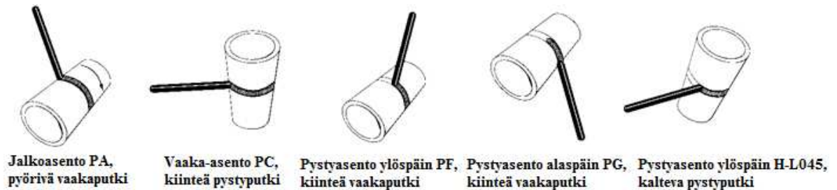
Kuva 5. Päittäishitsiasennot putken hitsauksessa [3].
