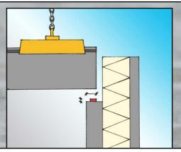
INSPECT THE LENGTH OF THE BEARING SURFACE AND THE LEVEL AND LOCATION OF THE INSTALLATION SHIMS AT THE WEB OF THE SLAB.
