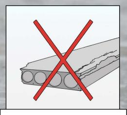
DO NOT LIFT A DAMAGED SLAB. CONTACT THE SITE SUPERVISOR.
