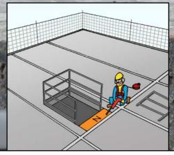
NOTCH THE LIFTING NECK OFF ONLY AFTER THE JOINT GROUTING HAS BEEN SET. BLOCK AND COVER THE AREA FROM BELOW.
