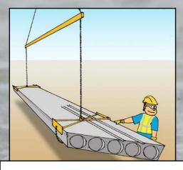
CLAMPS CAN BE USED TO LIFT REINFORCED LONG CANTILEVERS.
