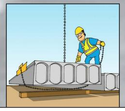
TIGHTEN AND LOCK THE SAFETY CHAIN WHEN THE HEIGHT OF THE SLAB IS LESS THAN 100 MM.
