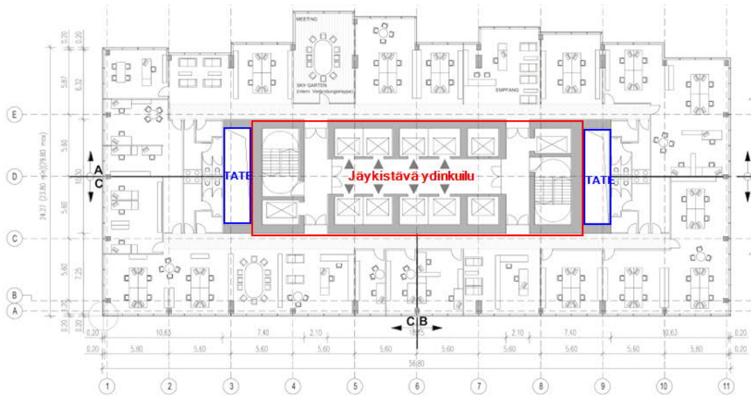
Kuvia 7.6: Vienna Tower, Talotekniikkakuilujen sijoittelu jäykistävän ydinkuilun ulkopuolelle.
