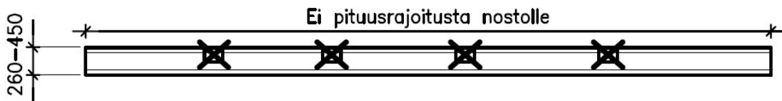
Kuva 3.7. 6-onteloisen ontelolaatan kavennus.
